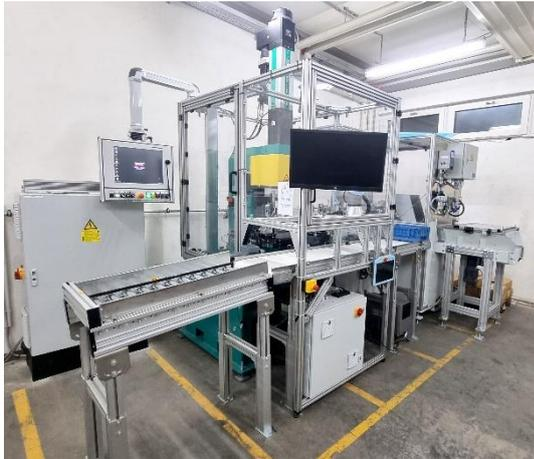
**Bild 1:** AI-pro wählt für das automatisierte Stauchen von Kugelhülsen eine C-Bügel-Pressen der TOX PRESSOTECHNIK GmbH & Co. KG und ergänzte diese um die notwendigen Handling- und Sortiereinheiten.
