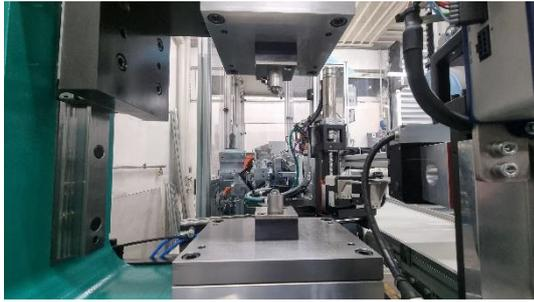
**Bild 4:** Bereit für das nächste Bauteil: Sobald eine Kugelhülse im Werkzeug sitzt, fährt der Antrieb den Stößel herunter. Die für das Kraft-Wege-Protokoll notwendige Strecke erfasst ein Resolver direkt am Servoantrieb, ein integrierter Kraftmesser steuert die dabei aufgewendete Presskraft bei.
