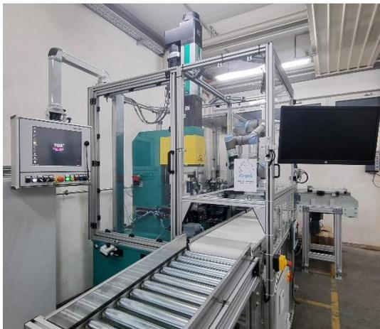
**Bild 6:** Der TOX-ElectricDrive-Antrieb ist in einer massiven und verwindungssteifen Stahlkonstruktion verbaut, die der Kraftereinwirkung während des Pressvorgangs genügend Stabilität entgegensetzt.
