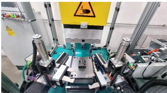
**Bild 3:** Zwei lineargeführte Greifer legen abwechselnd ein Bauteil in das Werkzeug der TOX-Servopresse ein und entnehmen es nach dem Pressen.
