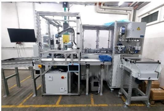
**Bild 2:** AI-pro entwickelte eine Anlage, um Kugelhülsen automatisch zu stauchen. Die Umformung übernimmt eine stabile Servopresse von TOX PRESSOTECHNIK, die anfangs einmalig oder bei einem Teilewechsel über die TOX-HMI konfiguriert wird. Das Start- und Stopp-Signal gibt dann die AI-pro-Automation vor.
