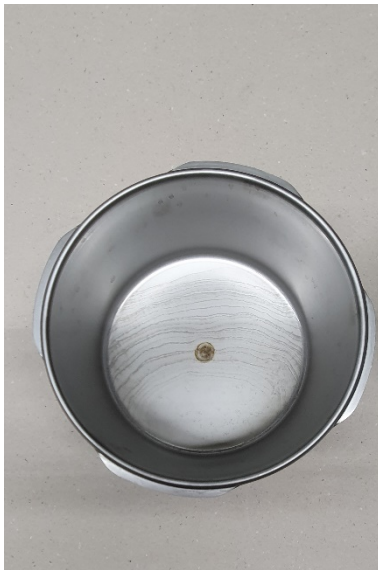
Bild 3: Ein einzelner Schweißpunkt verbindet den Boden, Topf und Aluminiumronde passgenau.
